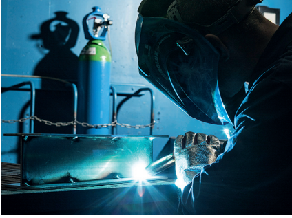
Alüminyumda MIG kaynağı
